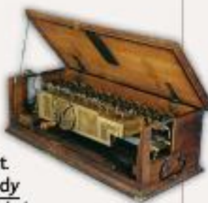
Machine à calculer conçue par Leibniz, qui permet d'effectuer les quatre opérations.
